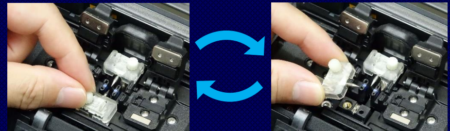
Sustitución de electrodos sin herramientas
